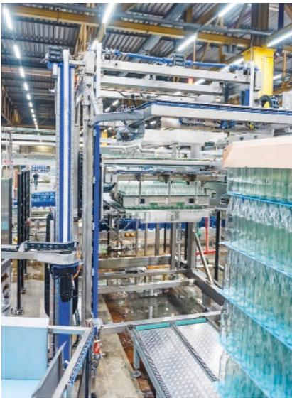
Mit dem installierten Neuglasabräumer Unipal 202 kann Gerolsteiner die aussortierten Fehlflaschen maschinell durch Neuglas ersetzen.
