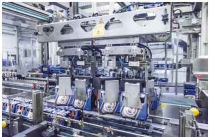
**Aufgebaut ist das Unimodul als Portalroboter mit zwei Achsen. Mit Achse 1 lässt sich die gleiche Flaschenzahl automatisch umpacken. Bei einer ungleichen Flaschenzahl kommen beide Achsen zum Einsatz**
