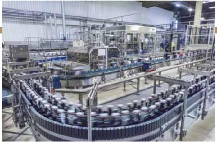
**Herzstück der Linie ist ein Unimodul, eine multifunktionale und kombinierte Ein-, Aus- und Umpackanlage**
